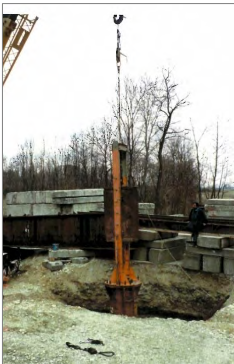
Slika 3: Dinamični obremenilni preizkus. (Ksenija Štern)
