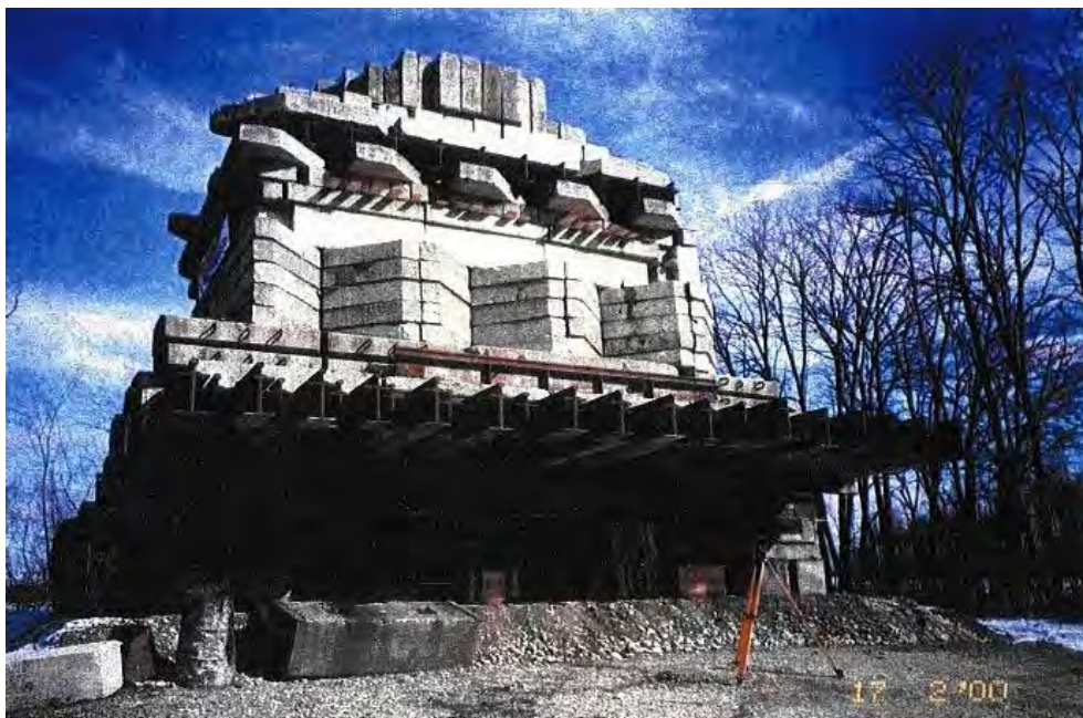
Slika 6: Obremenitev pilota z balastno obtežbo, most č Muro (Ksenija Štern).
