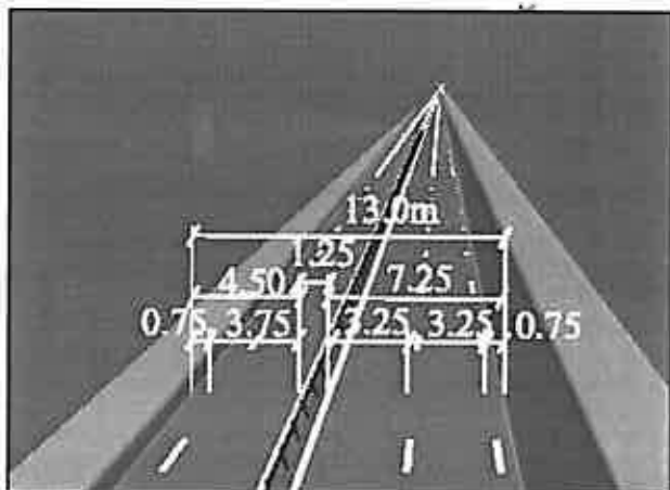
Slika 4. Standardni prečni profil ceste 2+1 na Švedskem ob preureditvi obstoječe ceste širine 13 m - smerni vozišči ločeni s sredinskim ločilnim pasom in varnostno ograjo [5]
