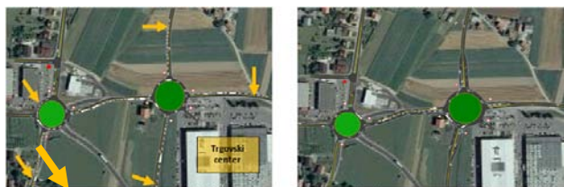
Slika 9: Simulaciji različnega odvijanja prometa (nastanek zamud/kolon) v odvisnosti od geometrije križišč (primer bodočega prometnega omrežja mesta Brežice za plansko leto 2030).
