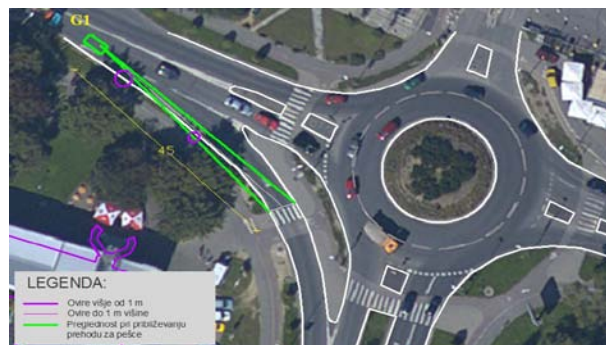
Slika 7: Grafični prikaz analize preglednosti (dejanska in minimalna potrebna preglednost v križišču) [7]
