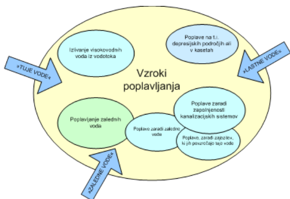
Slika 5: Viri poplavne nevarnosti. Protiukrepi so učinkoviti, če poznamo vzroke poplavljanja.
