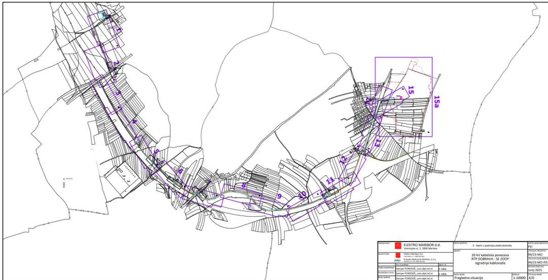
PREDVIDENA TRASA 2X20 KV KABLOVODA
