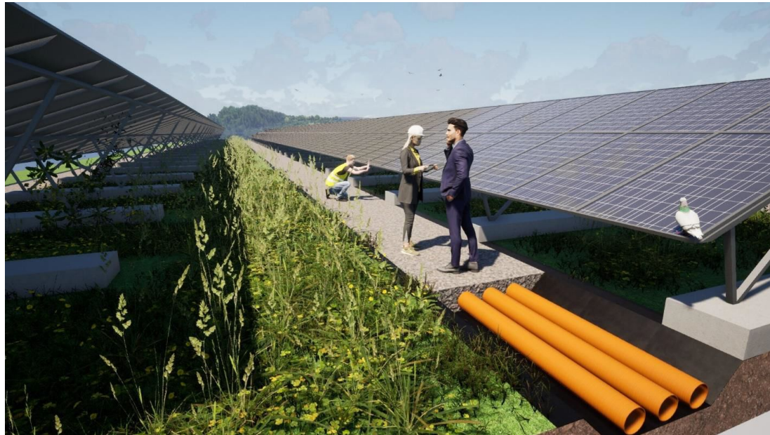
PRIKAZ NAČINA ZBIRANJA METEORNIH VODA V DRENAŽNE JARKE
